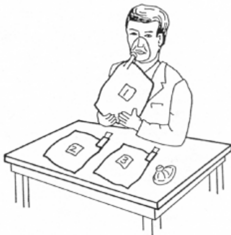
図 19 三点比較式臭袋法による臭気指数算定に関わるフロー
